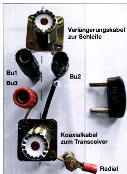
Bild 4: Anschaltplatte für die Variante 2 am Einspeisepunkt der äußeren Schleife
