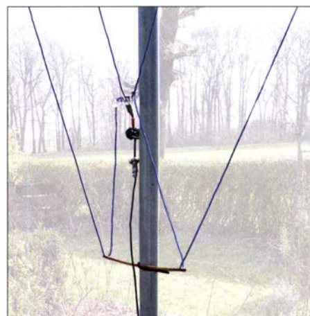
Bild 6: Seitliche Ansicht der Einspeisestelle für beide Schleifen bei Variante 3
