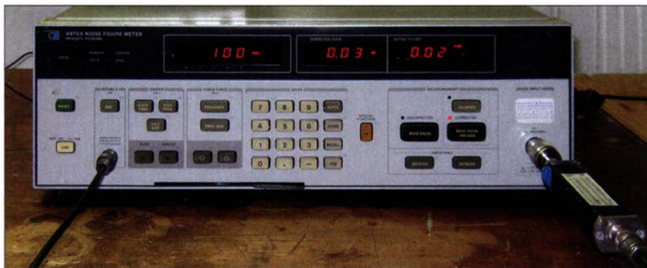
Bild 1: HP8970A-Rauschmessplatz nach der Kalibrierung; rechts ist die Rauschpegeltabelle des Herstellers auf der kalibrierten Rauschquelle HP346B zu erkennen.
