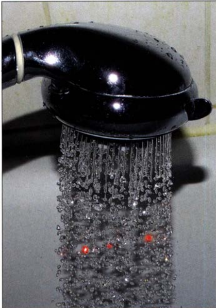
Bild 3: Bei diesem Experiment mit einem Duschkopf trifft der Laserstrahl immer wieder andere Tropfen des Wasserstrahls.
