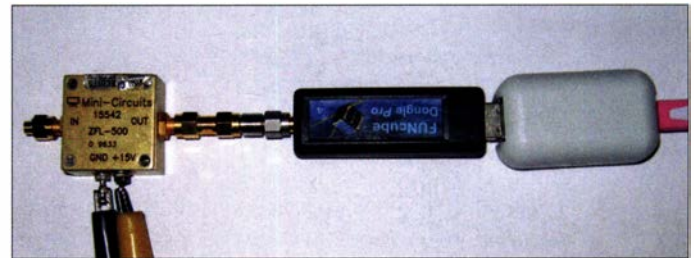
Bild 7: Messaufbau von links nach rechts; Messobjekt ZFL-500, koaxiales 10-dB-Dämpfungsglied, FUNCube SDR, USB-Isolator
