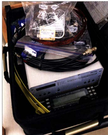
Gepäcktröley im Handgepäckformat mit Transceiver, PA, Antennenkabel, Draht und diversem Zubehör: Gesamtmasse knapp 10 kg
