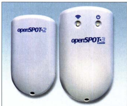
Bild 1: Größenvergleich zum Openspot 2, li.; neu am Openspot 3 sind zwei Taster, links WLAN, rechts Ein/Aus. Foto: DL1YBL
