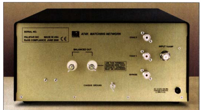
Rückseite des AT4K mit Anschlussklemmen sowie Aus- und Eingangsbuchsen
