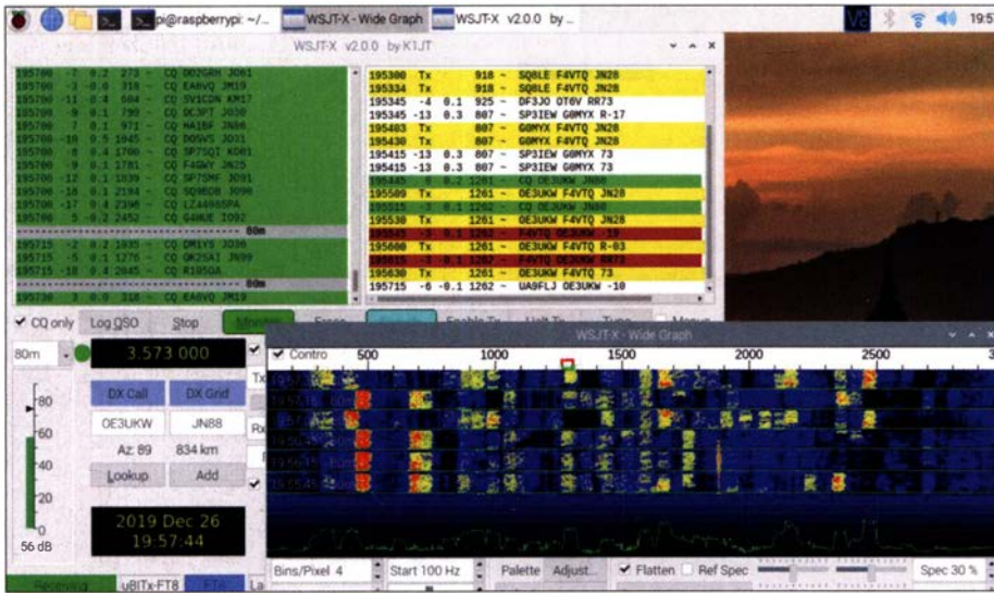
Bild 9: Screenshot des auf einem Raspberry Pi 4 laufenden Programms WSJT-X während des Betriebs des \mu BITX in FT8 Fotos, Screenshots: PE3ES
