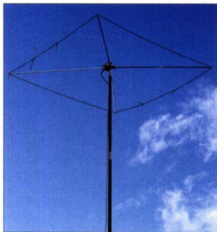
Bild 1: Fertig aufgebaute Antenne; links und in der Mitte sind die beiden Aluminiumrohre zu erkennen.
