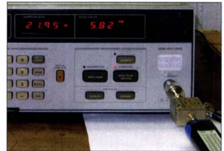
Bild 4: Die Vermessung des ZFL-500, goldene Box rechts, bei 100 MHz ergibt eine Verstärkung von etwa 22,0 dB und ein Rauschmaß von rund 5,8 dB, was doch deutlich von den Datenblattwerten abweicht.
